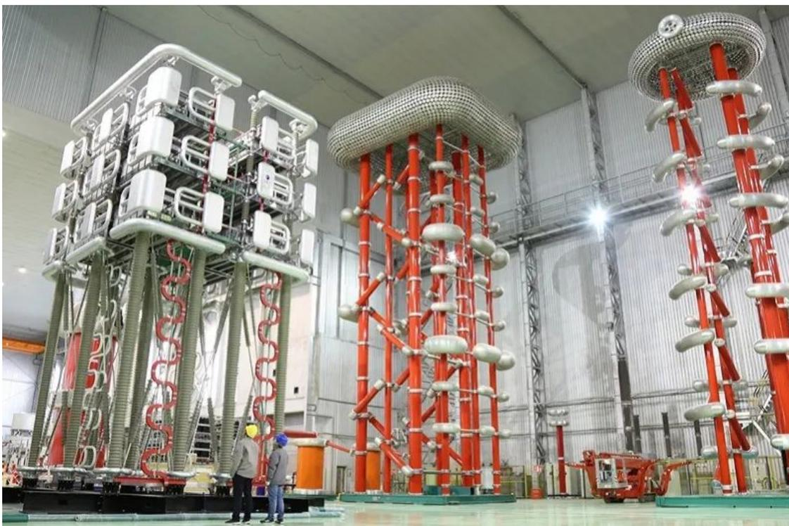
▲国网智研院科研人员在先进输电技术全国重点实验室开展柔性直流换流阀测试前检测
